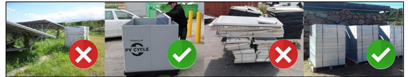
Illustration 28 : Conditionnement des palettes de panneaux photovoltaïques usagés
